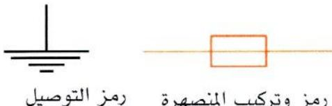
**المنصهرة:** تركب المنصهرة على الطور دائمًا، وفي حالة مرور تيار كهربائي تتجاوز شدته الحد المسجل عليها، ينصلر السلك المكون لها ففتتح الدارة.
